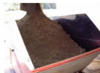
**Figura 38** – Tanque misturador
