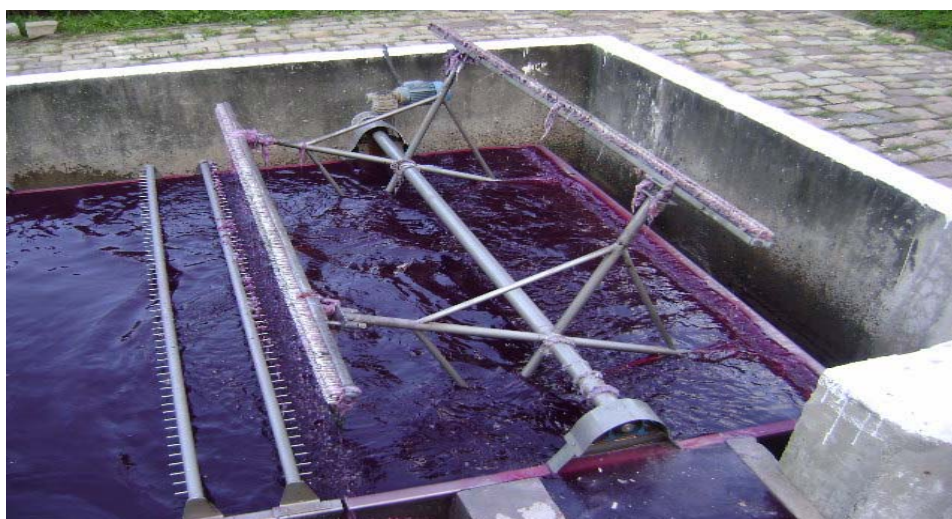
Processo de Peneiramento na entrada de efluente Fonte: Coteminas S/A
