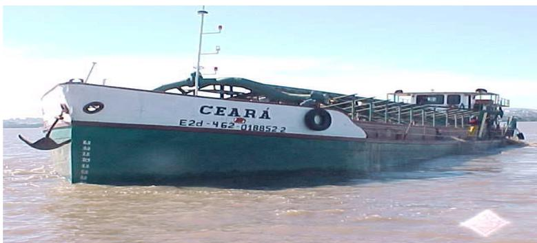
Visão do porte (médio) das dragas atuais. São mecanizadas, dispo de equipamento completo de sucção. Tem a capacidade de armazenar e transportar 200 m<sup>3</sup> (duzentos metros cúbicos) de areia por viagem.
