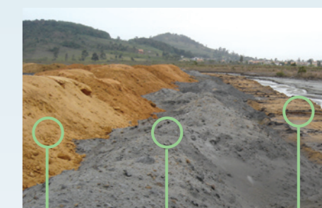
Camada de argila Cinzas da queima do carvão Situação original (rejeitos)
