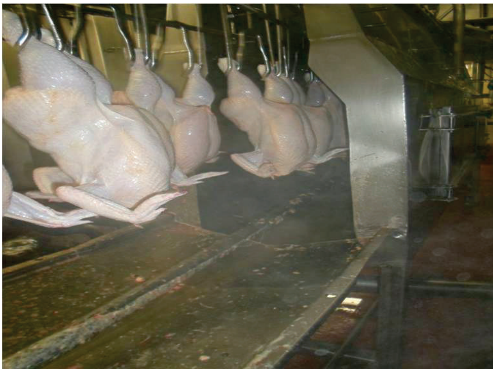
Chuveiro lavador do frango parcial
