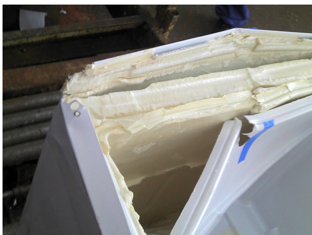
Poliuretano utilizado como Isolamento Térmico
