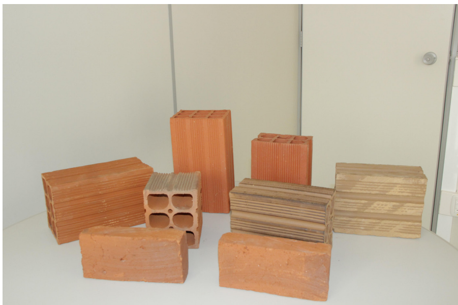
Tijolos produzidos com incorporação da argila ativada
