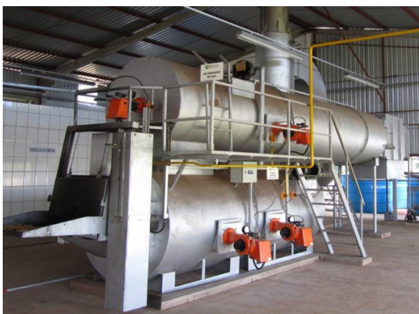
Processo de incineração dos resíduos dos Grupos B (risco químico) e E (pérfurocortantes)
