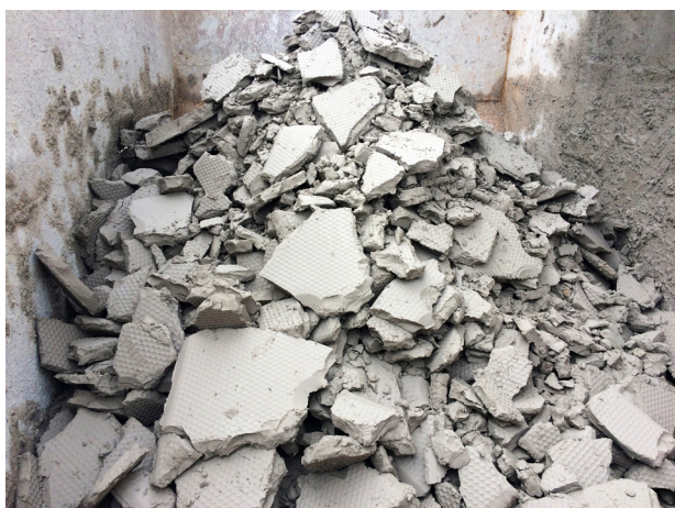
Lodo gerado na Estação de Tratamento de Efluentes, sem atomização
