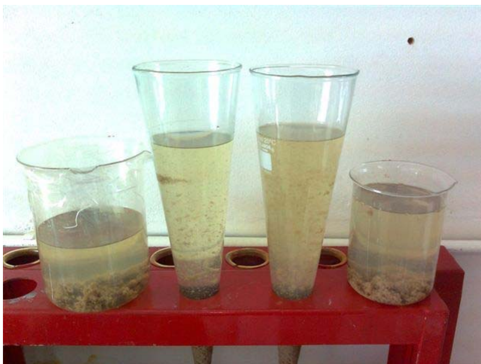
Figura 2 – Flocos formados (fundo dos recipientes) pela ação de Veta Organic em efluente de frigorífico. (Fonte: arquivo BWE).
