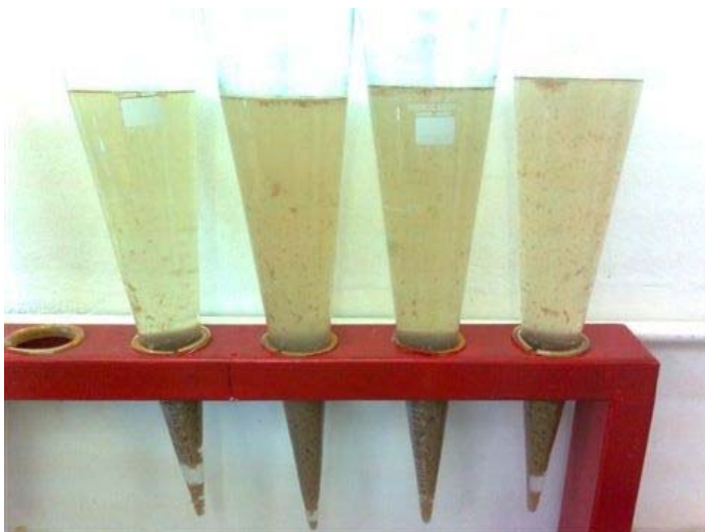
Figura 3 – Resultados dos testes de jarros (melhor proporção à esquerda). (Fonte: Arquivo BWE).
