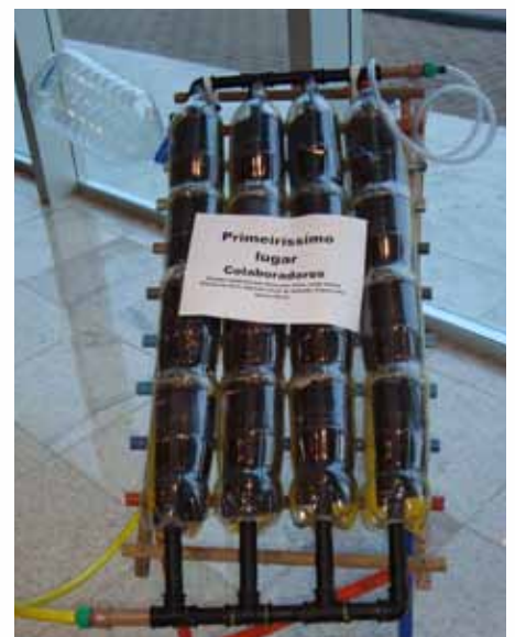
Com garrafas PET e canos, colaboradores construíram um aquecedor
